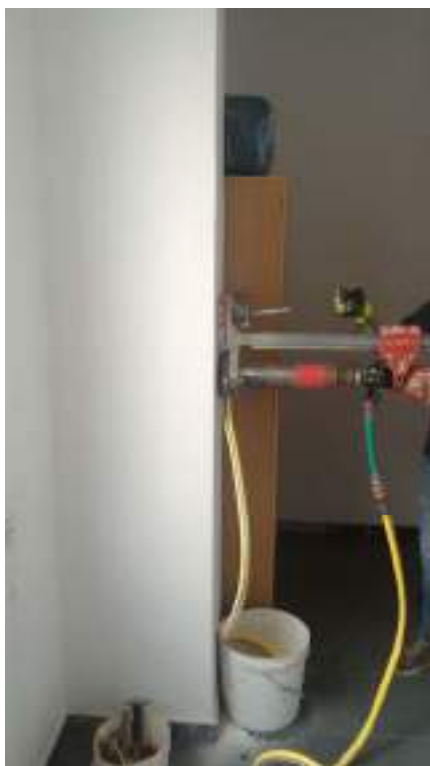
fig. 37 carotaggio pilastro piano 3 corpo 3 e parete con prelievo barre di armatura
